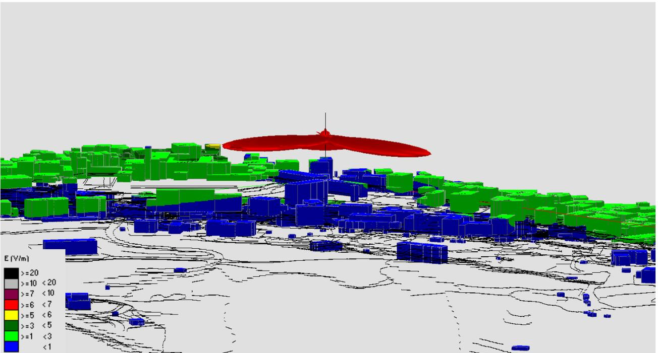
Fig. 6 Impatto Elettromagnetico – zona Borgo S. Stefano Centrale Telecom – Vista laterale
