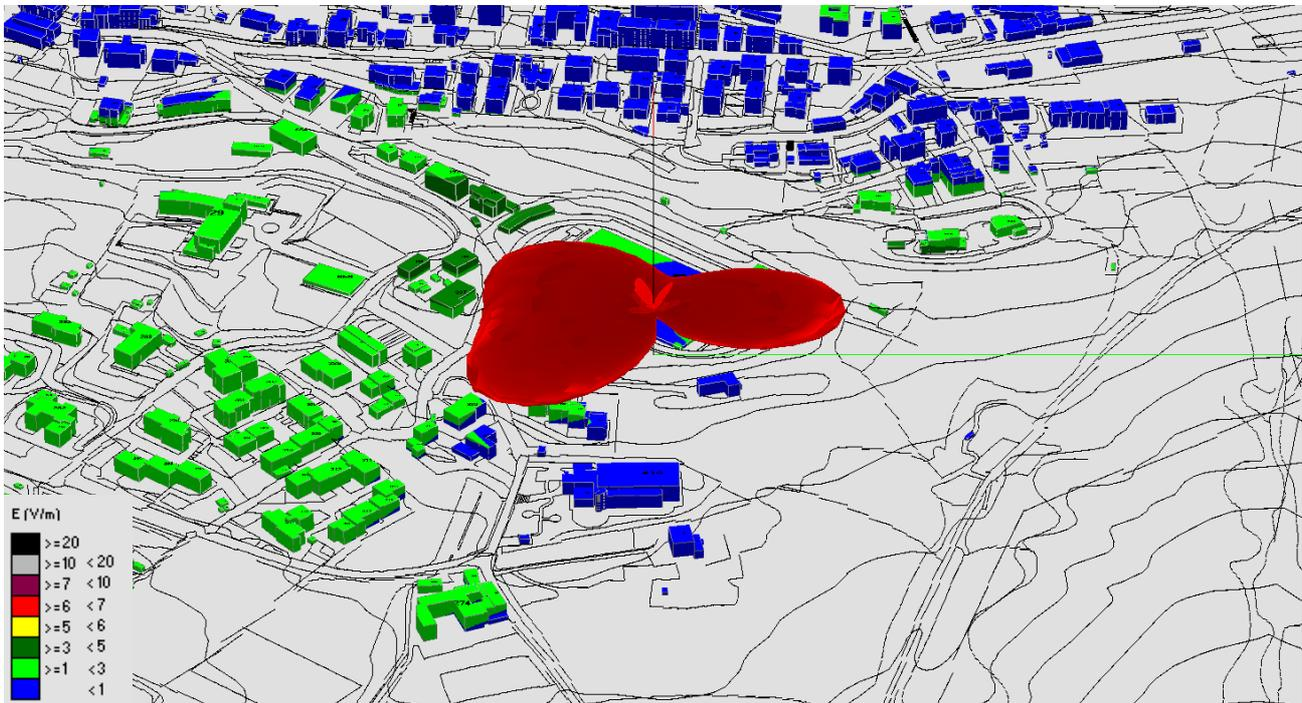
Fig. 11 Impatto Elettromagnetico – zona Volterra Campo Sportivo – 0° N
