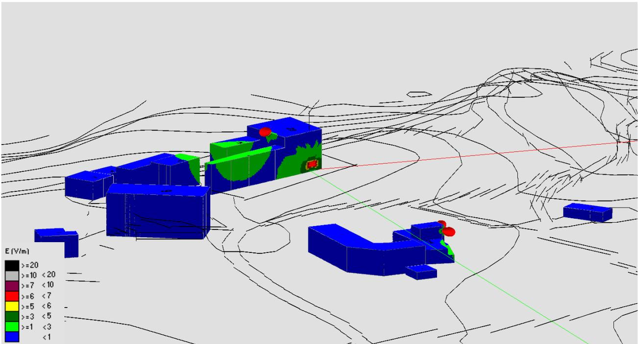
Fig. 20 Impatto Elettromagnetico – zona Località Pignano – Vista laterale
