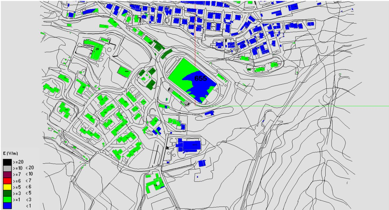
Fig. 12 Impatto Elettromagnetico – zona Volterra Campo Sportivo – Vista dall'alto
